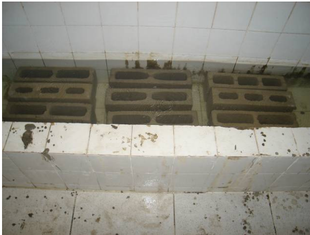
Figura 5 - Amostra na câmara úmida
