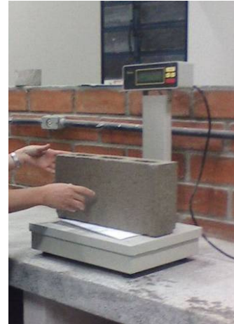
Figura 6 - Pesagem das amostras Saturadas
