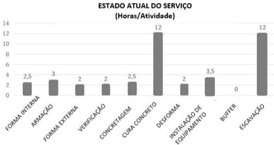
Figura 1 – Estado atual das operações das fundações
