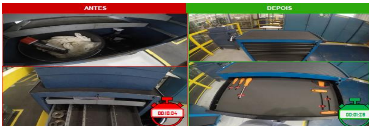
Figura 4 – Organização das ferramentas necessárias para troca de molde
