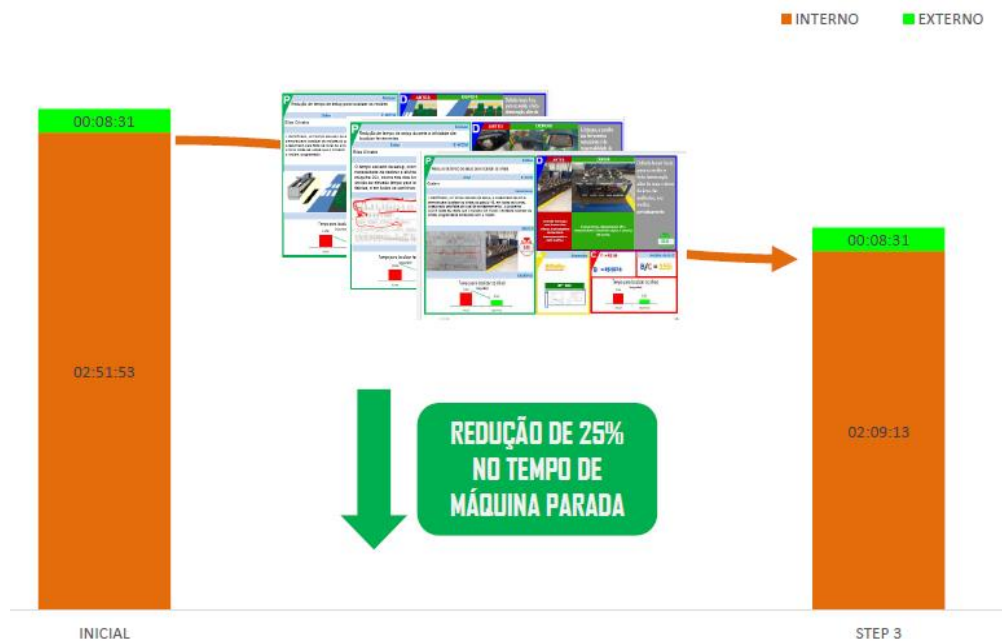
Gráfico 1 – Apresentação da primeira redução de tempo de set-up após diferenciação de atividades
