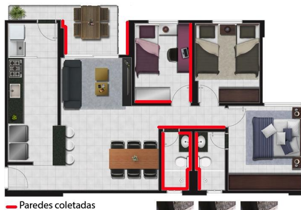
Figura 3 - Paredes executadas para coleta de resíduos
