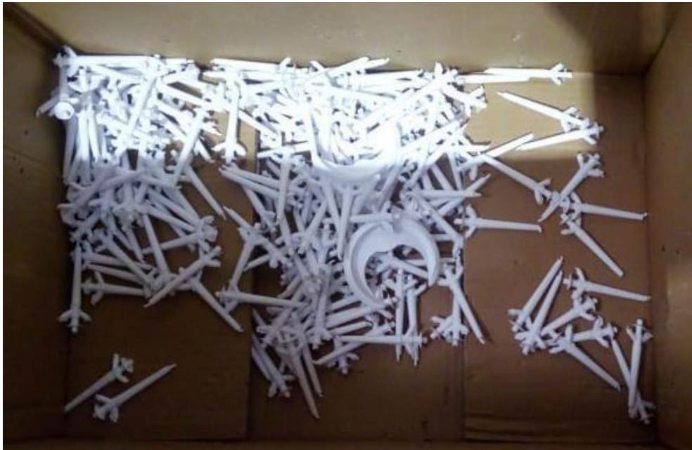
Figura 7 – Resto de material da injeção chamado de galhos de injeção
