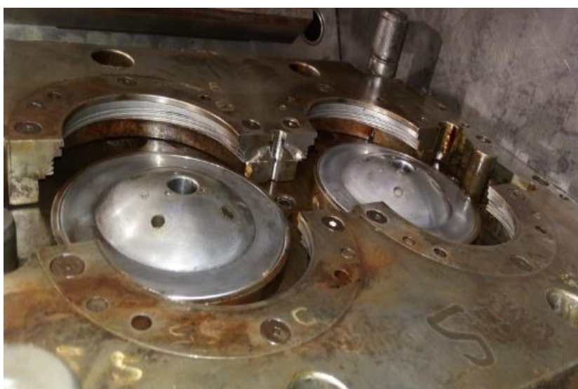
Figura 6 – Molde com gaveta aberta, para entrada de material
