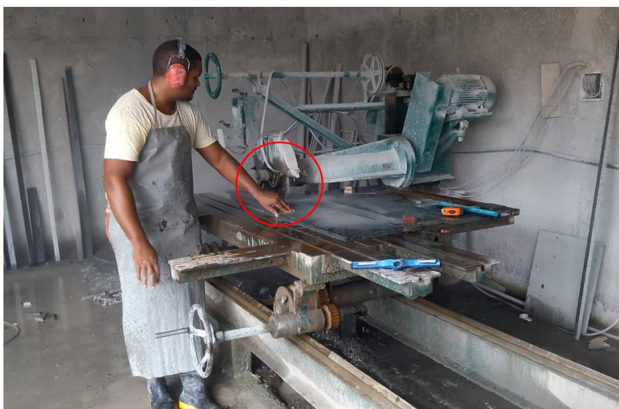
Figura 8 - Colaborador utilizando a serra grande de maneira incorreta
