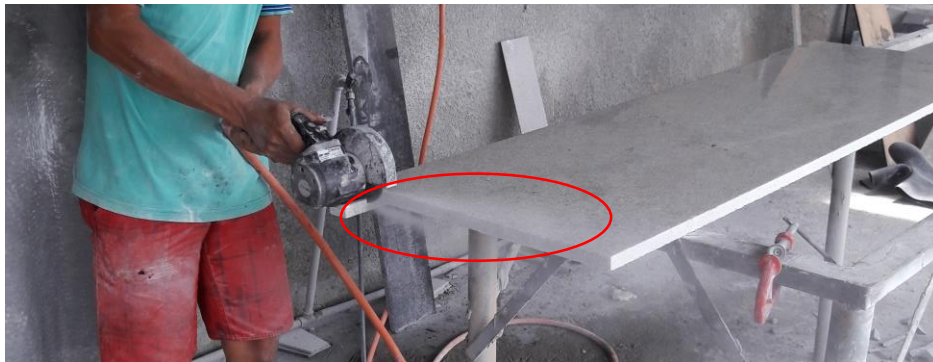
Figura 6 - Poeira de sílica gerada durante o corte
